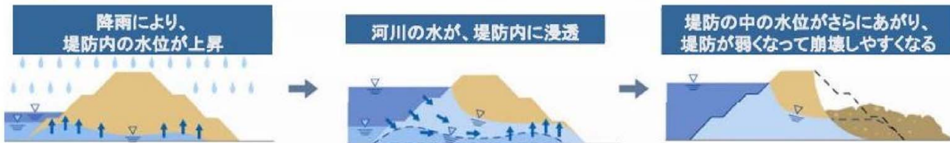
▲裏のり面のすべり破壊
